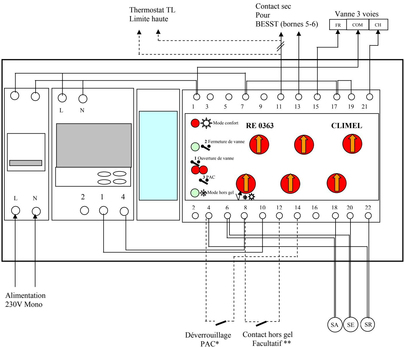
(\*) Le bouton « rep 1 » interdit le fonctionnement de la PAC pour une température extérieure inférieure à la valeur réglée. Le contact « déverrouillage PAC » déroge cette interdiction
